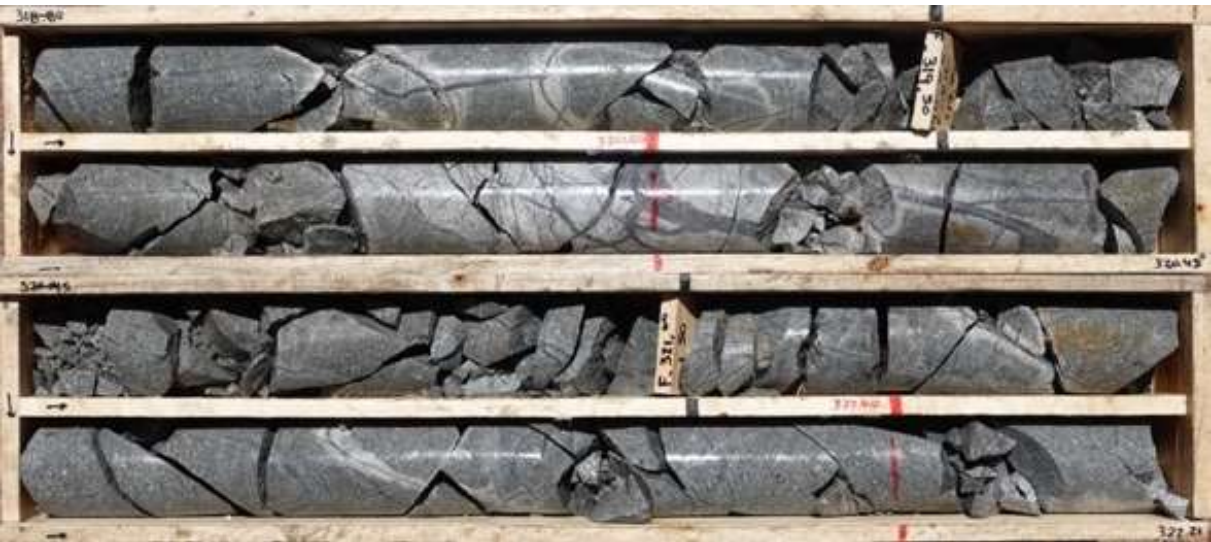
Hole PIU06: Chalcopyrite-chalcocite-pyrite sulfide assemblage
