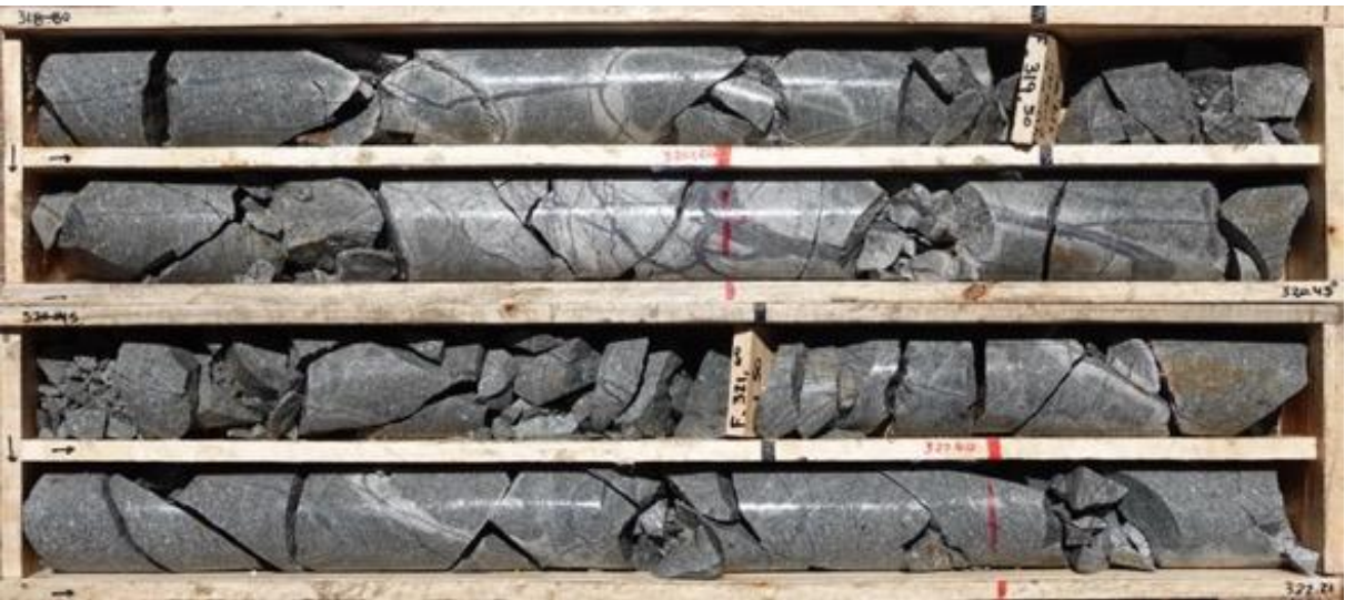
Hole PIU06: Chalcopyrite-chalcocite-pyrite sulfide assemblage
